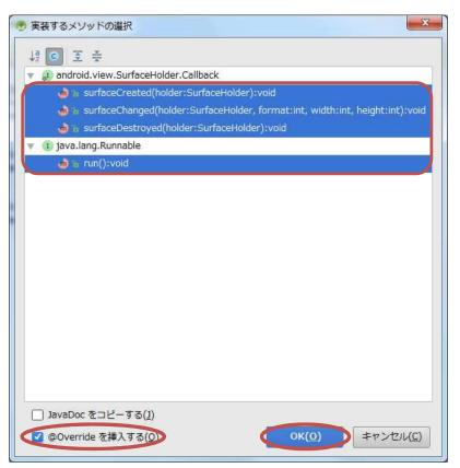
これで3個のコンストラクタ及び4個のメソッドが次のページの図の様に自動生成されるので、 更に自作のメソッド surfaceInit を付け加えると共に、コンストラクタには surfaceInit メソッド の呼び出しを記述し、自動生成された4個のメソッドのうち surfaceCreated、surfaceDestroyed 及び run の3個のメソッドのそれぞれを実装する。
