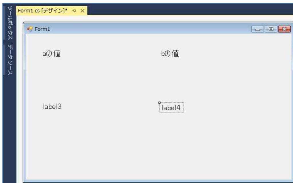
ツールボックスで『TextBox』を選択してから、左にある縦の『ツールボックス』タブをクリックして、メニューを引っ込める。フォーム上でドラッグしてテキストボックスを『label1』の右に貼る (『textBox1』の名前が付く)。プロパティのフォントサイズを 14 ポイントに変更する。
