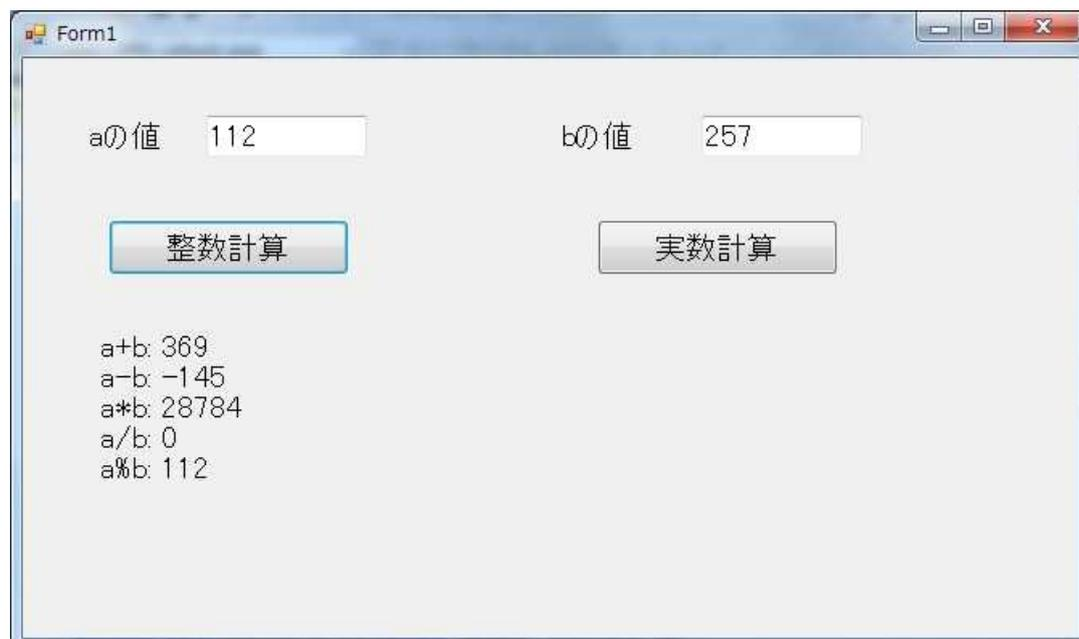
次に、一度プログラムを終了させてから再度起動し、2 つのテキストボックスに実数値を入力して、『**実数計算**』ボタンをクリックして、ラベルに計算結果が表示されることを確認する。
