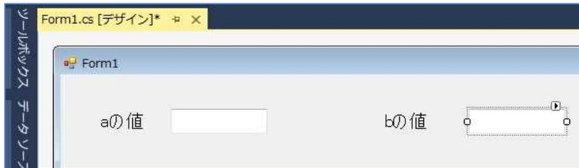
ツールボックスで『Button』を選択してから、左にある縦の『ツールボックス』タブをクリックして、メニューを引っ込める。フォームをクリックしてボタンを左のテキストボックスの下に貼る(『button1』の名前が付く)。『button1』のプロパティのフォントサイズを14ポイントに変更する。プロパティの『Text』を「button1」から「整数計算」に書き換える。
